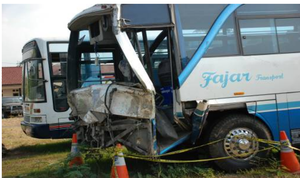
Gambar Sarana 11 : Kerusakan pada bus pariwisata Fajar Transport B 7061 WB
