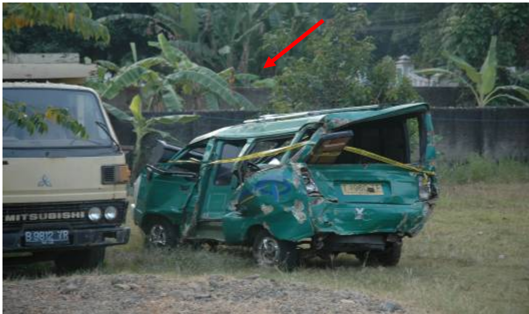
Gambar Sarana 15 : Kerusakan pada mobil angkot Nomor Polisi T 1960 TF
