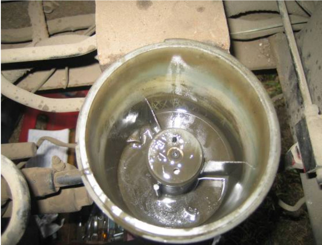
Gambar Sarana 8 : Minyak Rem Dalam Tabung Reservoir Habis
