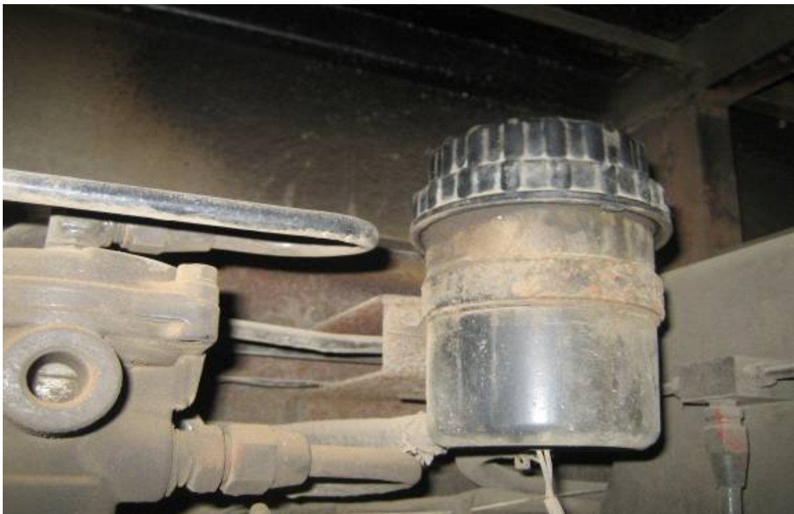
Gambar Sarana 7 : Tabung Pengisian Minyak Rem Terletak Dibawah Dek Penumpang
