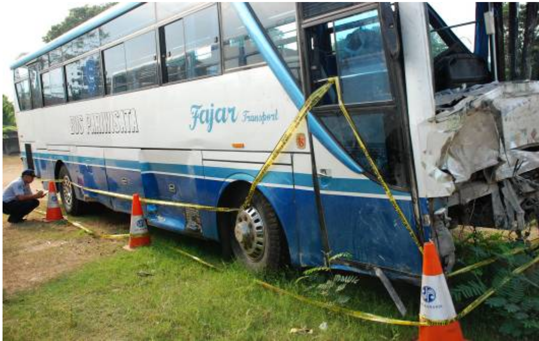
Gambar Sarana 12 : Kerusakan bus pariwisata Fajar Transport samping kanan
